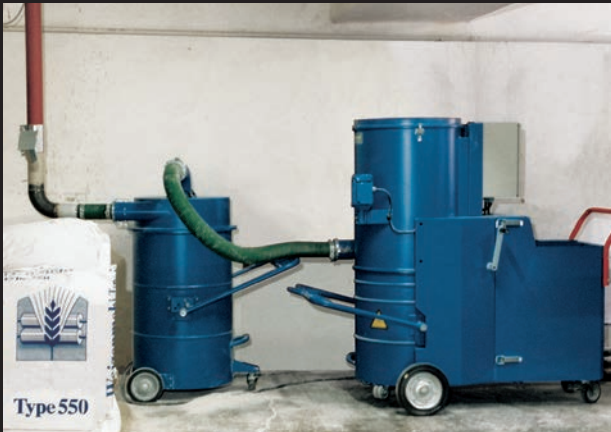
Abscheider-Aufsatz für 216-Liter-Fässer
