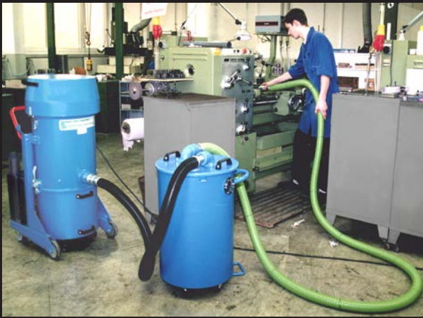
Vorabscheider für Flüssigkeiten, 95-Liter Inhalt
