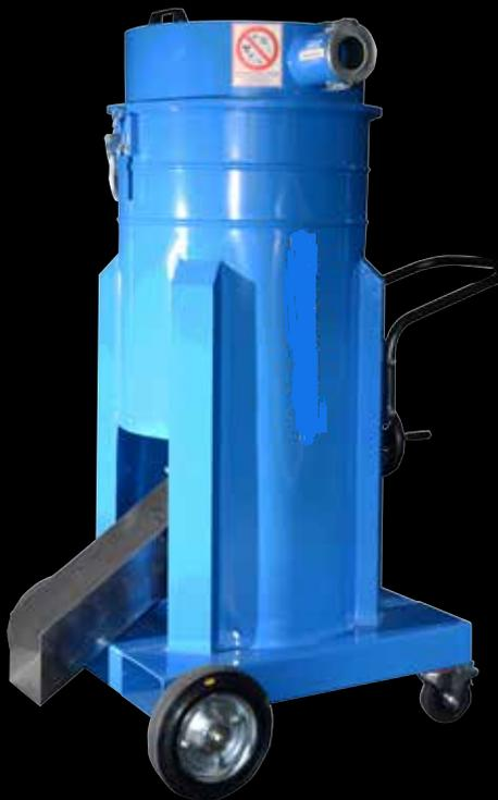
Die Entleerung des eingesaugten Strahlmittels erfolgt schräg nach vorne. Nachdem der VA-150 S vollgesaugt ist, wird er an die Förderrinne, den Bodenrost oder eine sonstige Strahlmittelförderanlage herangefahren und das eingesaugte Material kann bequem, schnell und vor allem ohne Kraftaufwand durch Öffnen des Entleerungsschiebers entleert werden. Vorabscheider für Strahlmittel mit größerer Sammelkapazität auf Anfrage.
