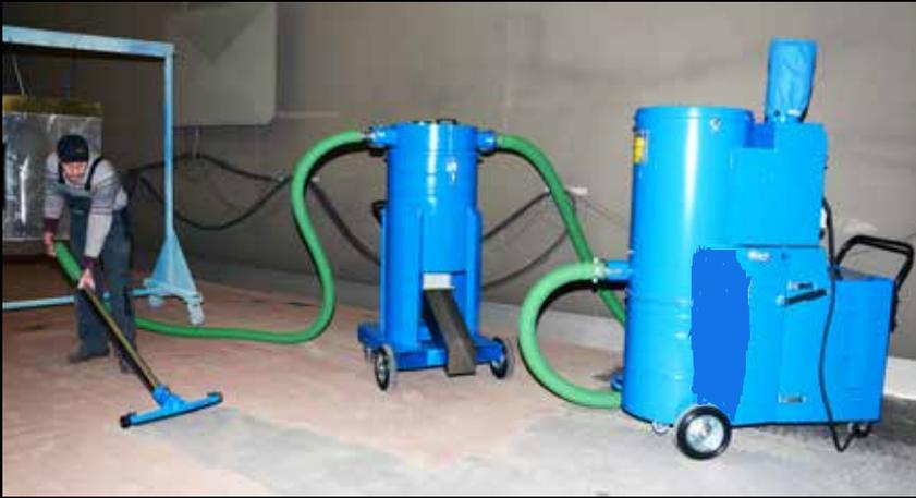
Spezieller Vorabscheider für metallisches Strahlmaterial, der in der Regel - je nach Strahlmaterial und Saugsituation - zusammen mit einem 11 oder 20 kW-Industriesauger betrieben werden kann. Das Gerät ist besonders stabil gebaut, so dass bei 120 Litern Sammelkapazität sogar Saugmaterial mit Schüttgewicht 5 (Stahlstrahlgut) kein Problem darstellt.
