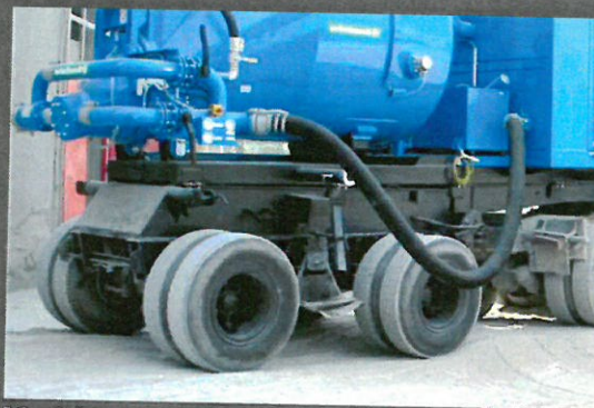
Verblasvorrichtung zum Verblasen des eingesaugten Materials in Silos, Gruben oder auf Dächer (Dachkies). Fluidisierung für schwer fließendes Material.
