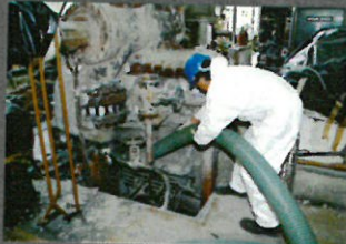
BlowVac Conic 2100 Diesel mit konstruktivem Explosionsschutz - Druckentlastung mit EVN-Ventil - Entkopplung der Rohrleitung durch Explosions-Rückschlagklappe
