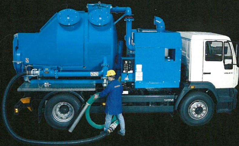
BlowVac Conic 2100 Diesel mit konstruktivem Explosionsschutz - Druckentlastung mit EVN-Ventil - Entkopplung der Rohrleitung durch Explosions-Rückschlagklappe
