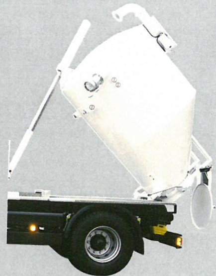
Hydraulisch betätigte Kippentleerung, Kippwinkel 46°
