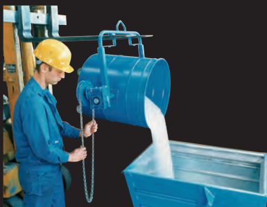
Getriebe-Kippvorrichtung zur kontrollierten Entleerung des Sammelbehälters
