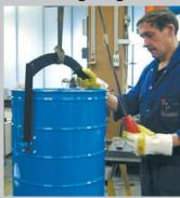
Der Sammelbehälter kann mit einem Transport- und Entleerungsbügel ausgerüstet werden, mit dem der Sammelbehälter mit Hilfe eines Krans oder Gabelstaplers angehoben werden kann.
