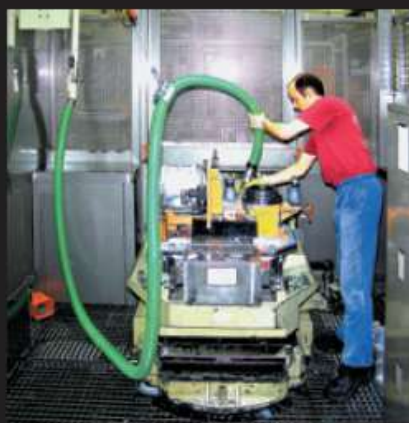
Maschinenreinigung in der spanabhebenden Fertigung. Saugen von Spänen und Kühlschmierstoffen über ein Rohrleitungssystem.
