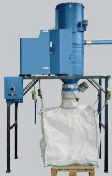
Entleerung in BigBags. Das Sauggut wird transportbereit der Anlage entnommen.
