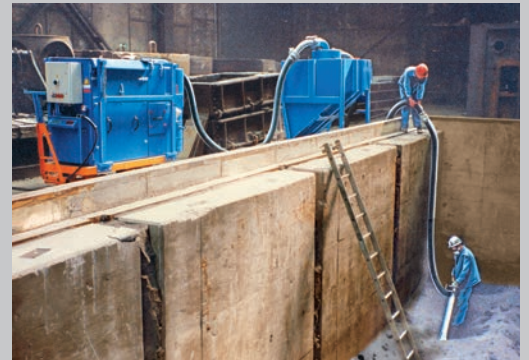
Schrägboden-Vorabscheider mit 1500 Liter Inhalt und für schlecht fließfähiges Material
