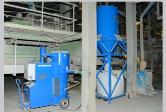
Vorabscheider für Schüttgüter, 1500 Liter Inhalt, staubarme Entleerung in BigBags
